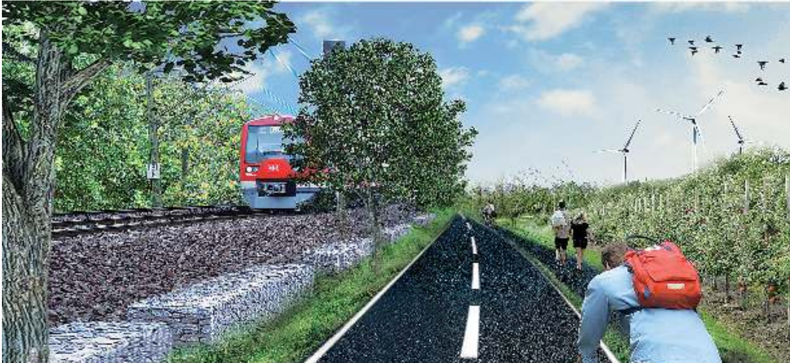
Vier Meter breit, asphaltiert und an bestehenden Strecken entlangführend – so könnten die Radschnellwege einmal aussehen.
